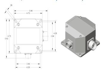
Nema 4X, Conduit Hubs (B6 enclosure)
